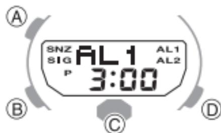
Индикатор включенного сигнала будильника с повтором сигнала
